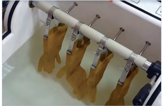
Испытание диэлектрических перчаток в ванне СВС-Ц серии
