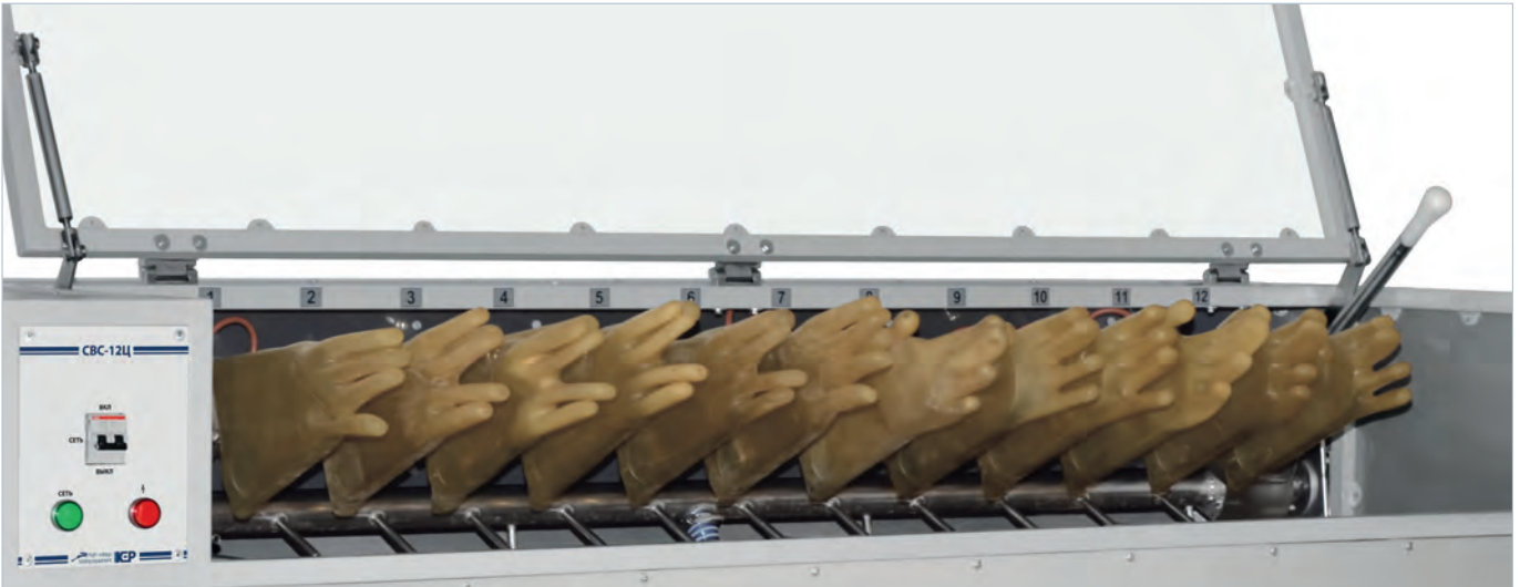
Испытание диэлектрических перчаток в ванне СВС-12Ц
