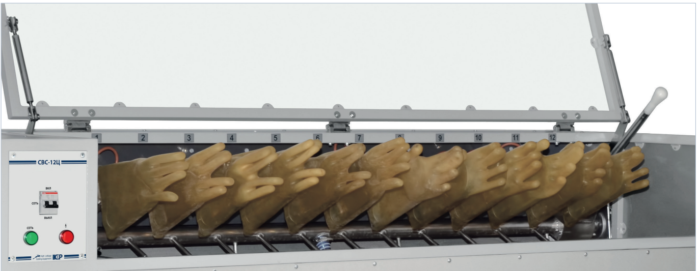
Испытание диэлектрических перчаток в ванне СВС-12Ц
