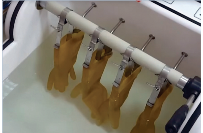
Испытание диэлектрических перчаток в ванне СВС-Ц серии
